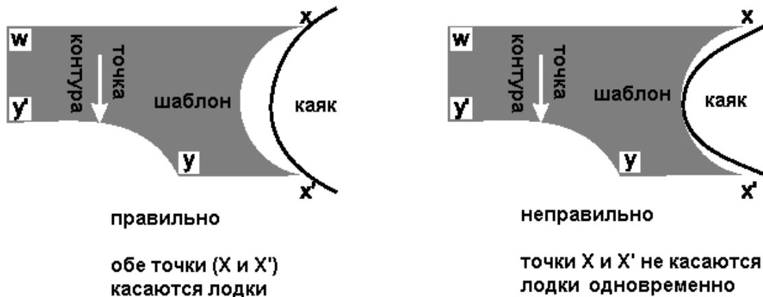
8.15.4. Шаблоны для проверки различных зон каяка следующие
