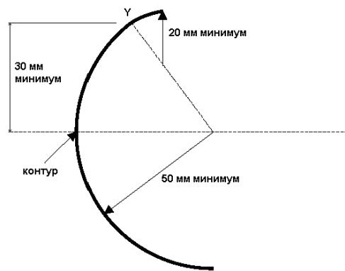
8.9.3. При виде сверху минимальный радиус кривой составляет 100 мм. Минимальная ширина 200 при достижении первых 100 мм длины каяка, начиная от задней части бампера.
