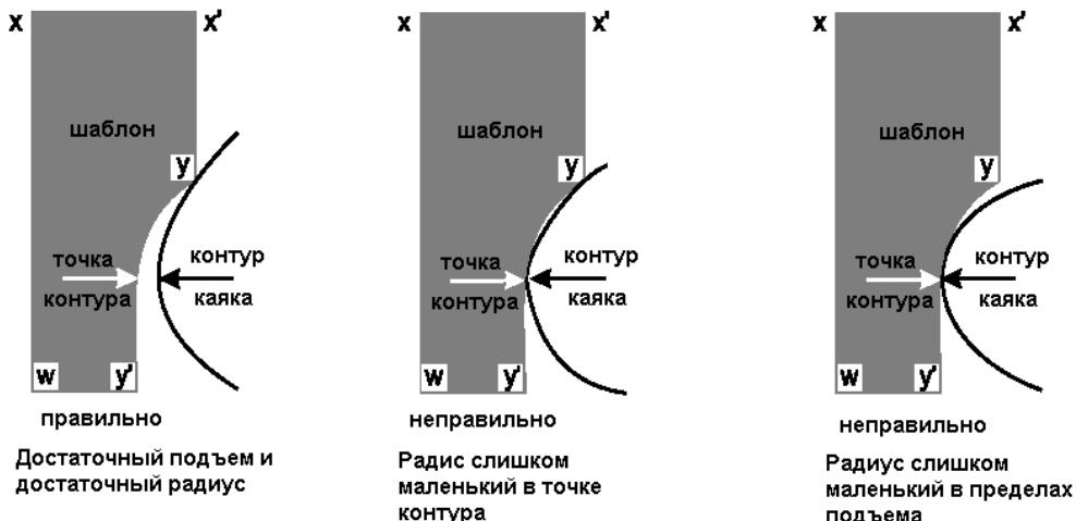
8.15.3. Для измерения радиуса кривизны соответствующая часть шаблона должен быть приложена перпендикулярно к проверяемой поверхности. Если обе точки (X и X') одновременно касаются поверхности каяка и в то же самое время остальная часть лодки не касается шаблона, то проверка считается пройденной.
